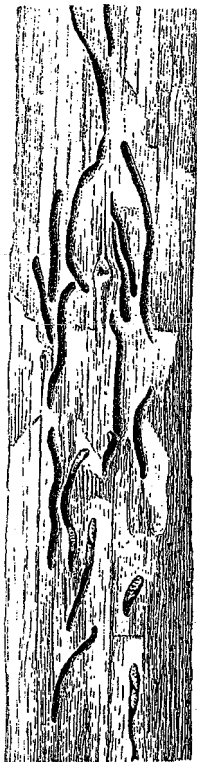
Fig. 195. Et lille Stykke Træ, der kun i kort Tid har været angrebet af Pælekrebs ( Limnoria ). Overfladen er bortskaaret over Gangene, saa at disses Forløb og Dyrene ses. Omtr. \frac{1}{2} 1).
