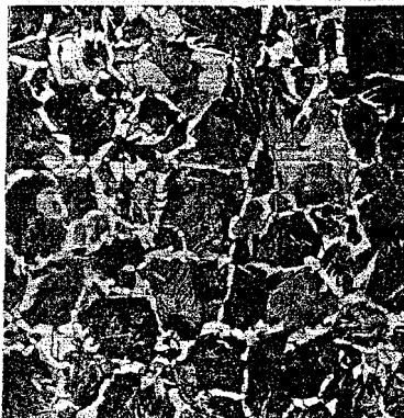
Fig. 70. Som Fig. 69, men kulrigere (Mærke 0,50), 0,55 C, 0,41 Mn, 0,040 P, 0,020 S. Perlit 1) med noget Ferrit (hvid).
